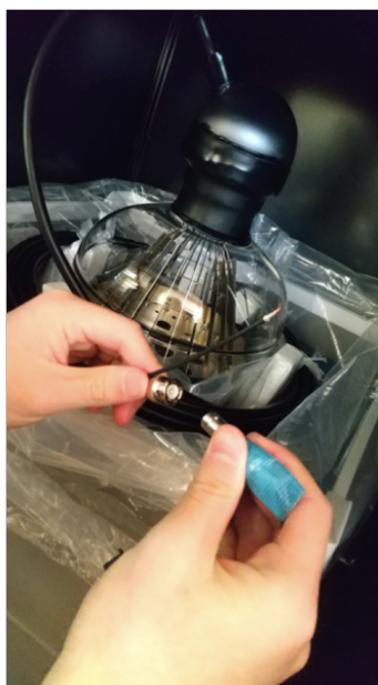
(b) 信号線接続 (BNC 接続)
