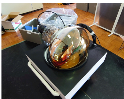
(a) PMT 目視確認用台座に乗せた HKPMT。
