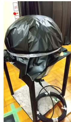
(b) ブラックシートを被せた PMT の様子
