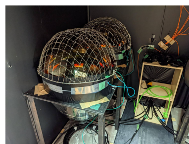
(c) PMT 設置完了時 (緑の導線でミューメタルとグラウンドを接続している。)
