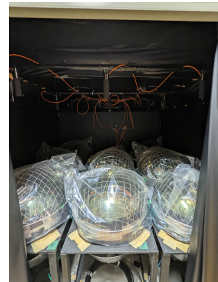
(e) 内部（PMT インストール後）
