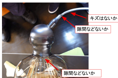
(b) 防水部、ケーブルの確認
