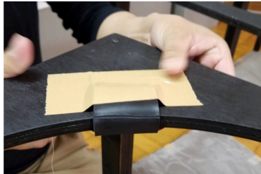
(a) PMT と台座が直接接触しないように台座の4点にラバーが取り付けられている。
