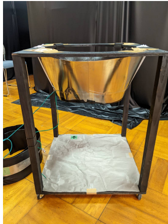
(b) ケーブルと直接触れないように台座下部のメタルシートを敷いている。
