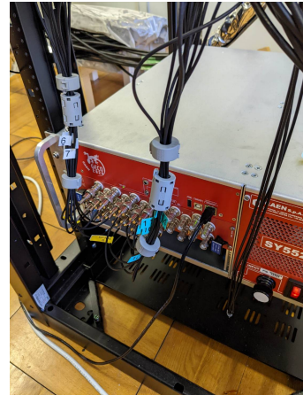
(c) ケーブルをまとめてフィラメントコアを取り付けている。(写真は HV 線)
